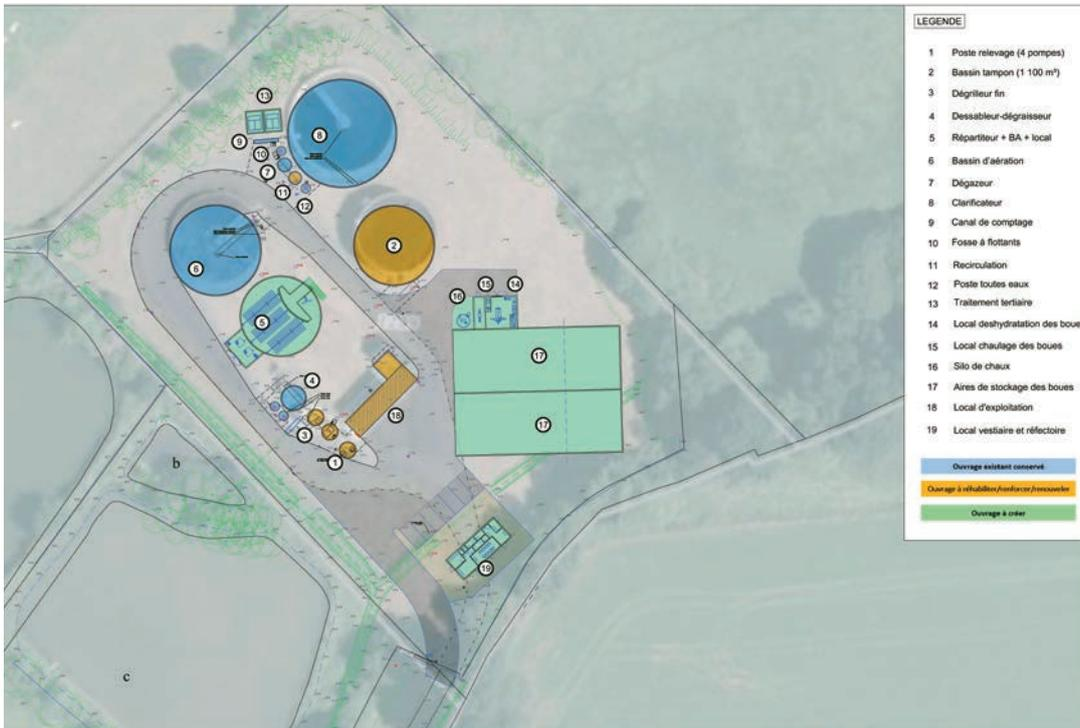
Implantation des ouvrages existants et projetés à Brécé (source SCE)
